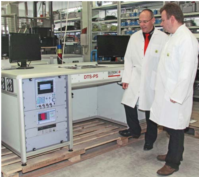
Michael Betz (links) und Klaus Thalheimer (Yokogawa) vor einem für die Auslieferung an einen Kunden vorgesehenen Stromversorgungstester. Im linken Unterschrank sind ein Oszilloskop und ein Leistungsanalysator von Yokogawa eingebaut.
