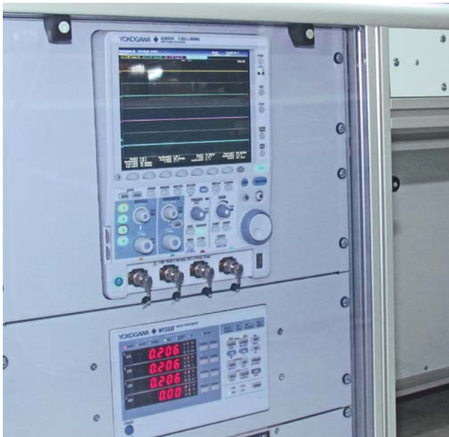
Oszilloskop der DLM2000 Serie und ein Leistungsanalysator der Serie WT300E in einem Prüfsystem für Stromversorgungen.
