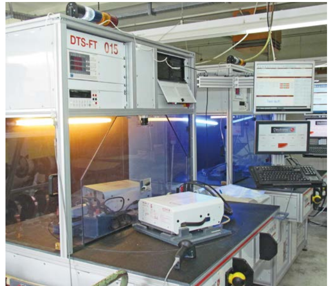
Testsystem mit Drehteller. Das zu prüfende Testobjekt wird vorn in die Halterung eingelegt und angeschlossen. Hinter der Glasscheibe ist das aktuell im Test befindliche Produkt. Sobald die Prüfung abgeschlossen ist, dreht sich der Teller und die Geräte tauschen die Plätze.
